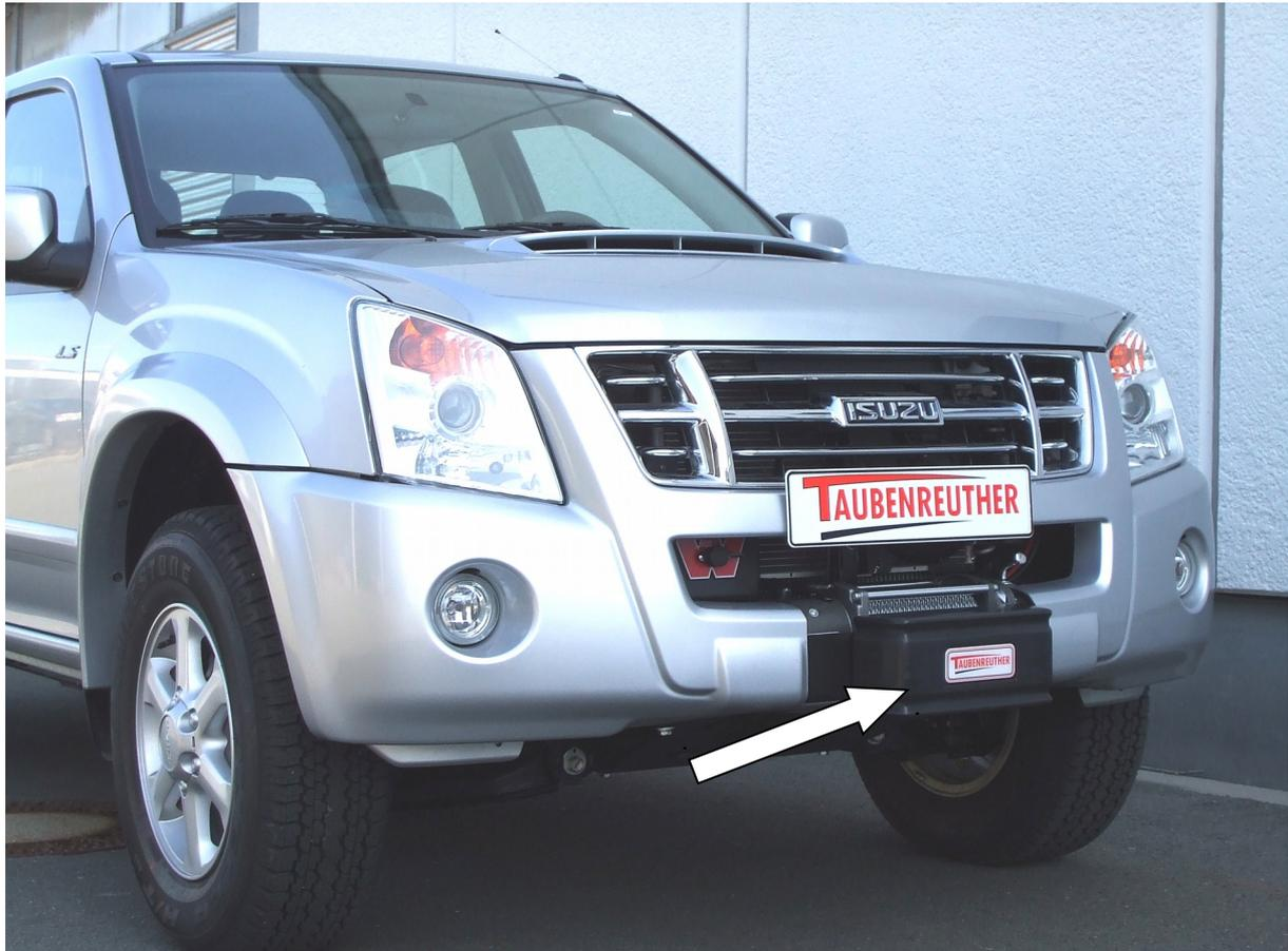
**Hier sehen sie den fertig montierten Seilwindenanbausatz.
